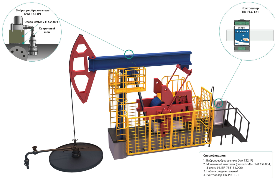
Рис. 2. Виброключ для отключения привода станка-качалки при нештатной работе, на базе вибропреобразователя DVA 132 (132P) и контроллера ТИК-PLC 121
